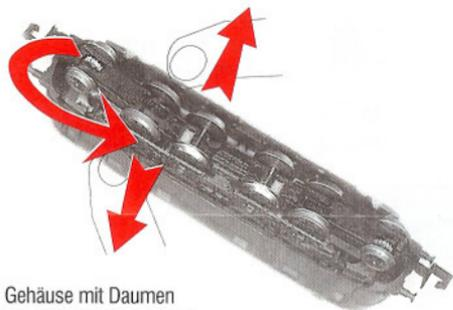
Gehäuse mit Daumen leicht nach außen ziehen. Mit Zeigefinger an der Rahmenblende Motorblock mit Fahrgestell nach oben herausziehen.
